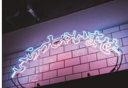
最近では小型のものが多くなったネオンサイン。ガラス管にネオンガスやアルゴンガスを封入し、電気を通して光らせる仕組みです。撮影：Taio Konishi 製作：マヴェリック
