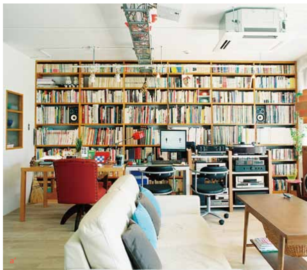
a, a' | 電気配線はすべて鉄管を通してコンクリート天井に露出配管。エアコンは業務用をボルトで吊り下げた。配線用ラックも本来は駅やビルで使われる“超”業務用。床にナラ材を使ったのは、「フローリングの定番だから」
